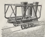
Wagonnet à pains de sucre
